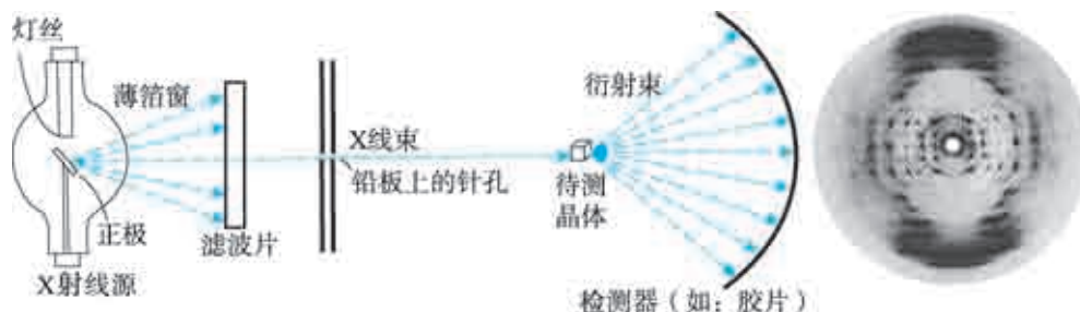
图 1-5 X 射线晶体衍射示意图
